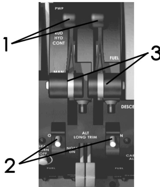
**1. THRUST REVERSER LEVER (L, R)**
